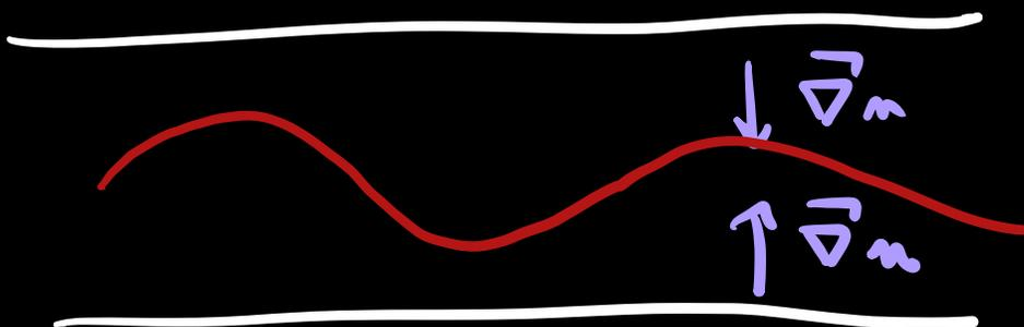
• Intérêt: on a la dispersion intermodale car les rayons d'angle élevé (modes grands) voient l'indice  $\oplus$  faible & se propagent  $\oplus$  vite.
