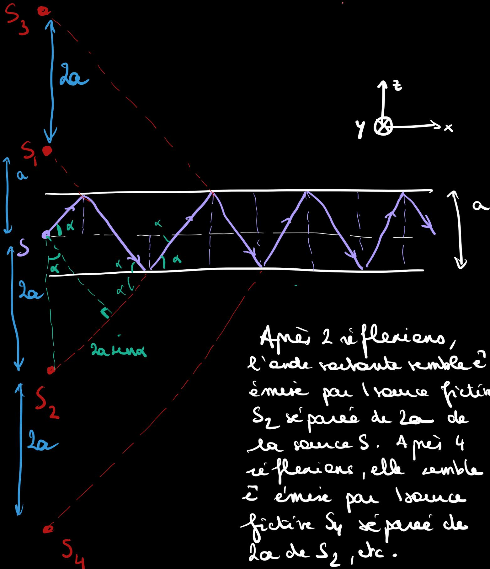
Après 2 réflexions, l'onde sortante semble émise par la source fictive  $S_2$  séparée de  $2a$  de la source  $S$ . Après 4 réflexions, elle semble émise par la source fictive  $S_4$  séparée de  $2a$  de  $S_2$ , etc.
